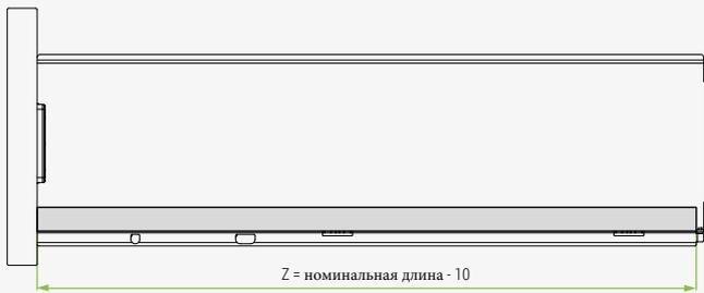
Крепление направляющих на фиксаторах Plug-In
