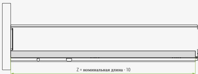
Крепление направляющих на фиксаторах Plug-In
